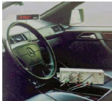
차량 실내에서 사용중인 TELEMETRY 시스템과 유리창에 부착된 지시계
